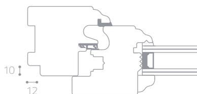
Esterno telaio ristrutturazione /
